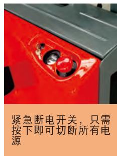
紧急断电开关，只需按下即可切断所有电源。
