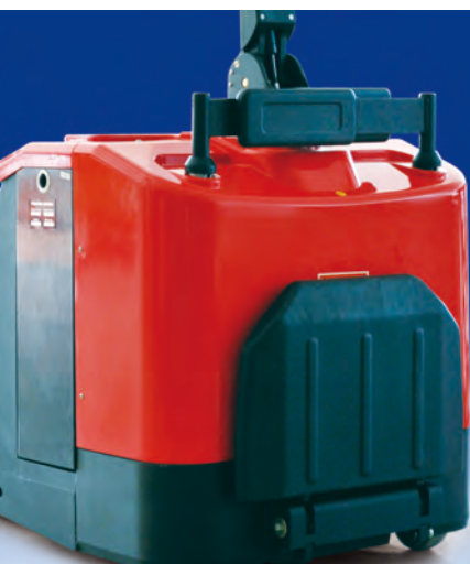
折叠式踏板，具有缓震功能，可消除操作者在行驶过程中路面给予的冲击
