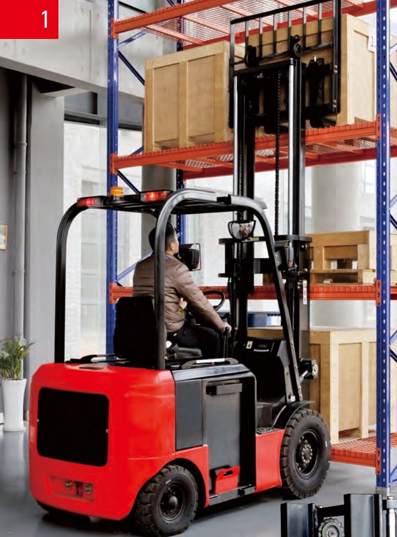
侧拉式电池组，维修更换便捷高效
